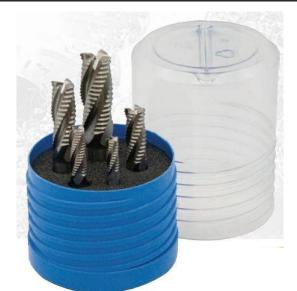
HSS-Co8 PROFILINE® Schaftfräser DIN 844, Typ NR kurze und blanke Ausführung mit Weldonschaft DIN 1835 B eine Schneide über die Mitte in blauer Rose Kunststoff Runddose 5tlg. 6,0 - 8,0 - 10,0 - 12,0 - 16,0mm
