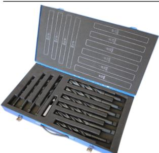
HSS RATIOLINE® Spiralbohrer DIN 345, Typ N, rechts mit Morsekegel, schwarze Ausführung, fließgepresste Qualität, Kegelmantelanschliff, Spitzenwinkel 118° im blauem Metall-Magazin 11tlg. 14,0-30,0 mm x 2,0 mm je 1 Stück + 25,0 mm + 1 Reduzierhülse MK3 auf MK2 Größen: 14 / 16 / 18 / 20 / 22 / 24 / 26 / 28 /
