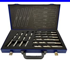
HSS-GK RATIOLINE® Spiralbohrer DIN 338, Typ N, rechts mit abgesetztem Zylinderschaft 13mm, kurze und blanke Ausführung, profilgeschliffene Qualität, mit Kreuzanschliff, Spitzenwinkel 118° im blauem Metall-Magazin 10tlg. Größen: 14 / 15 / 15,5 / 16 / 17 / 17,5 / 18 / 19 / 19,5 / 20mm
