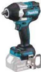
Ein kraftvoller 18 V Akku-Schlag-schrauber mit einem Anziehdrehmoment bis 700 Nm für die industrielle Fertigung und Bauanwendungen. 1/2"-Außenvierkantaufnahme mit Sicherungsstift. Mit Auto-Stopp-Funktion zur effizienten Energienutzung. Eine Doppel-LED hilft bei schwierigen Lichtverhältnissen.
